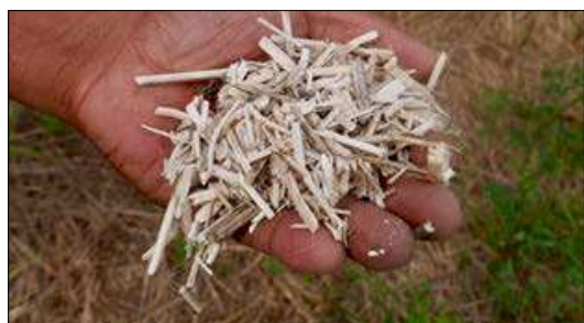
La chènevotte est principalement valorisée sous forme de paillage, de litière pour animaux ou pour la fabrication de 'béton chanvre'.
